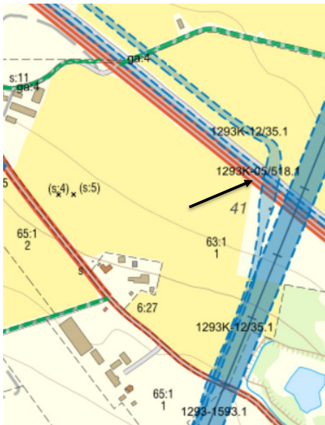
Figur 3: Ledningsrätterna är de blå områdena. Pilen visar en korsning av Hässleholms Vattens ledningsrätt och Svenska Kraftnäts ledningsrätt. (Källa: GeoVy, Lantmäteriet, hämtad 2019-06-04)
