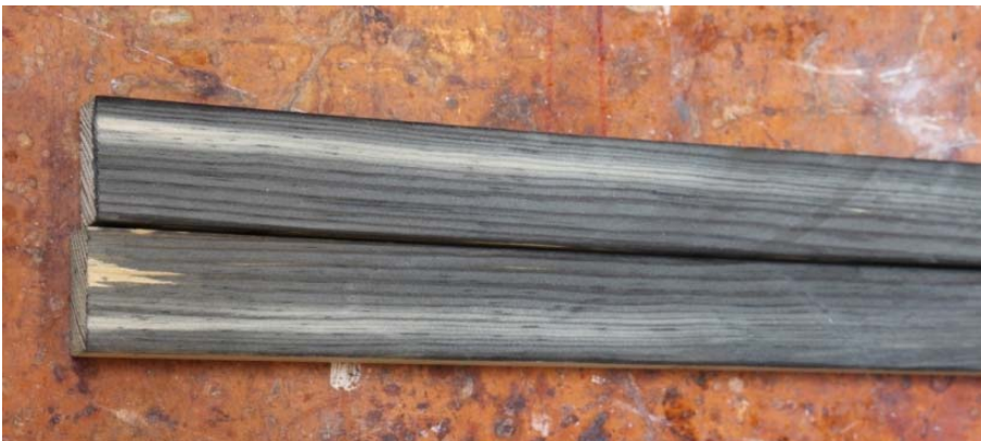
Bild 11: Axial inträngning av träskyddsmedel i standardprov av furu.
