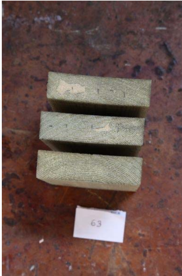
Bild 10: Inträngning furubrädprover. Uppifrån och ner 63.3, 63.2 och 63.1
