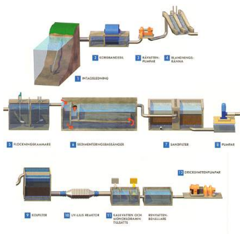
Figur 1- Schematisk bild över Norrvattens reningsprocess på Görvälnverket [7]
