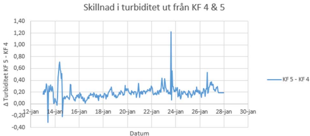
Figur 5 - Skillnad mellan turbiditeten [FTU] mellan KF 4 & KF 5. Försök där öppningstiden ändrades till 27 sekunder i KF 5 gjordes den 21:a januari. Under perioden innan ändringarna gjordes visade sig skillnaden i turbiditet vara i genomsnitt 0,17 FTU medan under veckan då toppen ändrats var skillnaden i genomsnitt 0,23 FTU.
